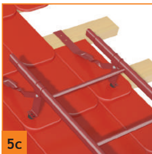
Установка кровельной лестницы на черепичную кровлю
