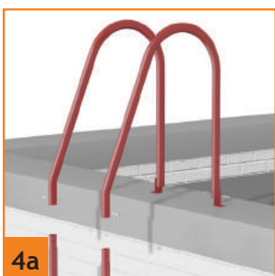
Установка кровельной лестницы на металлочерепицу
